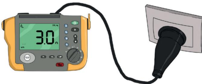
[2] A medida obtida é a resistência do **eléctrodo de terra** influenciada por todas as ligações à terra de facto e voluntárias, existentes na instalação.
